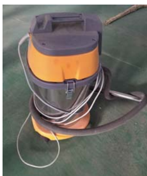
图 1 移动式除尘设备
